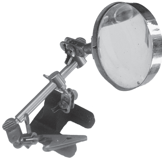
Figuur 3.4: Deze 'derde hand' is ook voorzien van een vergrootglas
